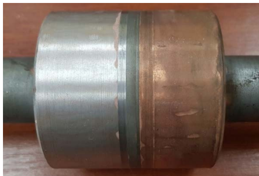
Рисунок 2 – Слой напыления медным и медно-цинковым порошком на фальшвал с наглядным подтверждением отсутствия дефектов после токарной обработки
